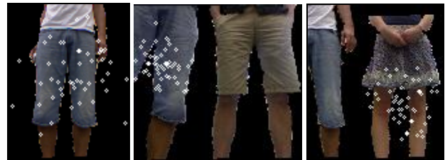
Abb. 3: Verschiedene Ansichten des Particle Filters, links: gefundene Zielperson, mitte und rechts: gefundene Zielperson trotz zweiter Person im Bild
